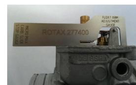
Rotax : exemple de contrôle fourchette flotteurs avec gabarit.
