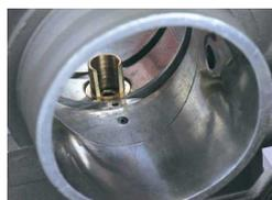
*À gauche, vue de la buse (en action quand on lève le boisseau) et du trou juste derrière d'où sort l'essence (en action au ralenti)*
